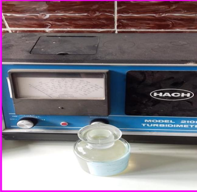
2. جهاز قياس العكارة ، Turbidity meter
